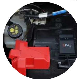
3. Conecte el FINDER a la batería. El cable rojo al fusible positivo (+). El cable negro al negativo (-)
