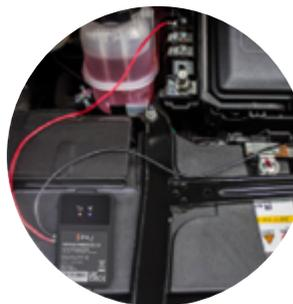
2. Conecte el FINDER a la batería. El cable rojo al fusible positivo (+). El cable negro al negativo (-)
