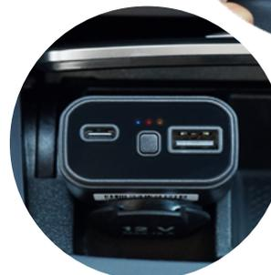
3. Los LED se encienden cuando el dispositivo está conectado correctamente
