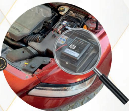
3. Conecte su FINDER a la batería. El **cable rojo al fusible positivo (+)** y el **cable negro al fusible negativo (-)**.
